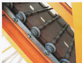
エプロンコンベアの部品の多くを自社製作。
