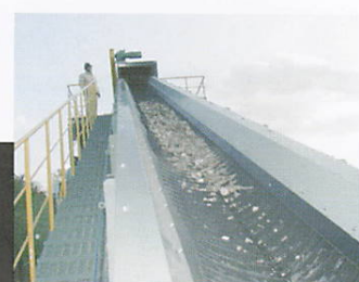
傾斜コンベア
