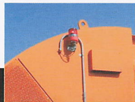
異常を感知しコンベアが停止した場合のバトライトもオプションで取り付け可。
