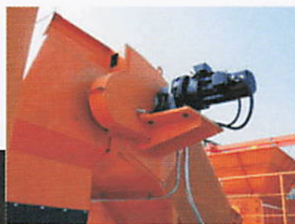
トルクリミッター付のサイクロ減速機で過負荷異常を検出します。
